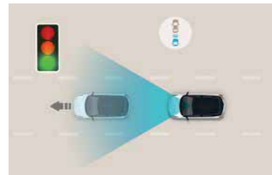
Leading Vehicle Departure Alert (LDVA) Avertit le conducteur si le véhicule qui le précède se remet en route et qu'il ne réagit pas à temps, par exemple dans les embouteillages ou à un feu de signalisation.
