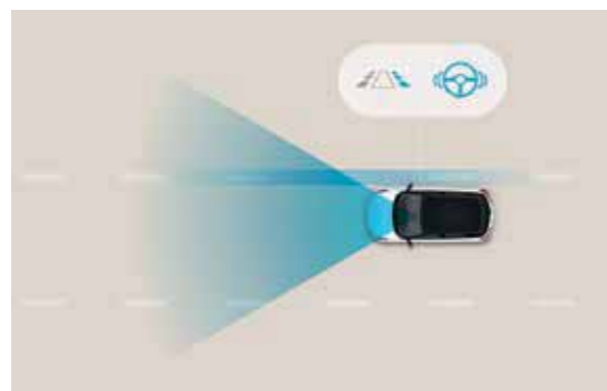
Lane Keeping Assist (LKA) Lorsque l'Assistance active de Maintien de Trajectoire remarque que votre voiture quitte sa bande de circulation, elle vous prévient ou modifie activement la trajectoire pour maintenir le véhicule sur sa bande.
