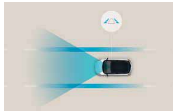
Lane Following Assist (LFA) Ce système garantit que la voiture reste au milieu de sa bande de circulation à des vitesses comprises entre 0 et 180 km/h, aussi bien sur autoroute qu'en ville.
