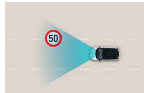
Intelligent Speed Limit Assist (ISLA) Le système intelligent d'avertissement de limitation de vitesse utilise la caméra frontale et les informations du système de navigation pour reconnaître les panneaux de vitesse. Il affiche en temps réel sur l'écran du système de navigation et sur l'écran TFT la limitation de vitesse et toute interdiction de dépassement.
