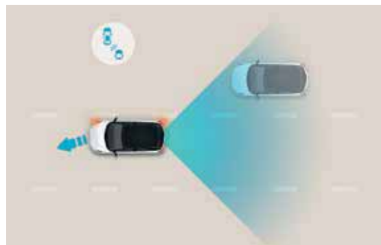
Blind Spot Collision-avoidance Assist (BCA) Avec 2 capteurs radar au bas du pare-chocs arrière, le système vous avertit visuellement de la circulation dans votre angle mort. Lorsque vous enclenchez votre clignotant à ce moment-là, vous entendez un signal sonore et la voiture freine automatiquement si nécessaire.
